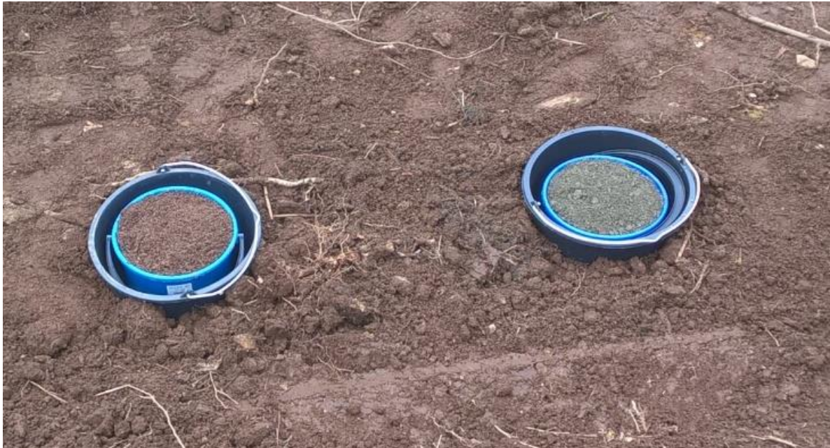
Kuva 6. Pyhäsalmen pilotointialueelle rakennetut mikrolysimetrit, vasemmalla kasvukerroksen materiaalia oikealla rikastushiekkaa.
