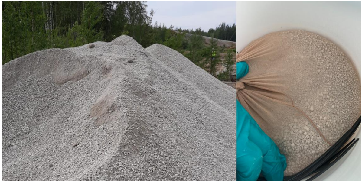
Kuva 44. Hituran reaktiivisissa rakenteissa käytetyt uusiomateriaalit: kalkkikivimateriaali vasemmalla ja geopolymeeri oikealla.
