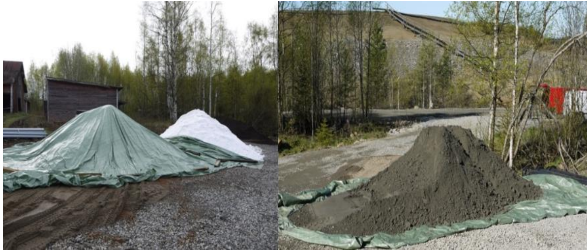
Kuva 3. Materiaalien varastointia Pyhäsalmen pilotointialueella, jossa vasemmalla tuhka ja kipsi, oikealla rikastushiekkaa.
