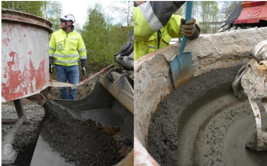
Kuva 5. Pyhäsalmen pilotoinnissa käytetyn tuhka-rikastushiekkaseoksen paakkumaisuus vasemmalla ja pakeneminen myllyn reunoille oikealla.
